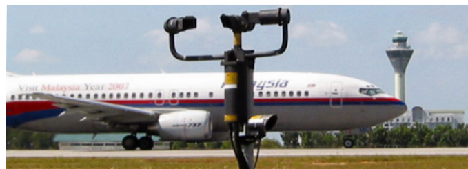
Датчики VPF были первыми датчиками прямого рассеяния, которые использовались в системе RVR, одобренной CAA Великобритании, на взлетно-посадочной полосе CAT III.
