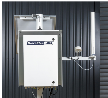
RPSG-07 установлен на станции измерения мощности гамма-излучения, работающей на солнечной батарее с датчиком осадков и регистратором данных AMS 111 Compact.
