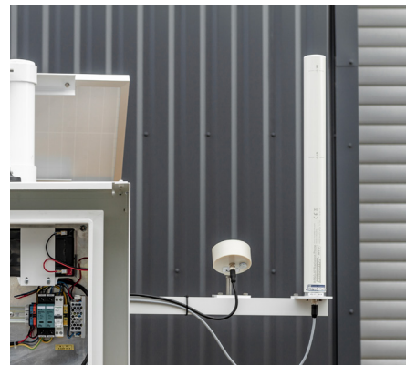
RPSG-07 установлен на станции измерения мощности гамма-излучения, работающей на солнечной батарее с датчиком осадков и регистратором данных AMS 111 Compact.
