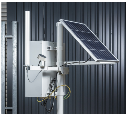
RPSG-07 установлен на станции измерения мощности гамма-излучения, работающей на солнечной батарее с датчиком осадков и регистратором данных AMS 111 Compact.
