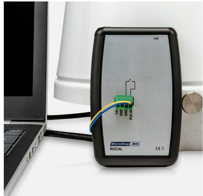
RGcal - это электронный счетчик импульсов, который подсчитывает касание осадкомера с опрокидывающимся ковшом и измеряет время между опрокидыванием ковша. Информация отправляется на ПК через стандартный USB-порт.
