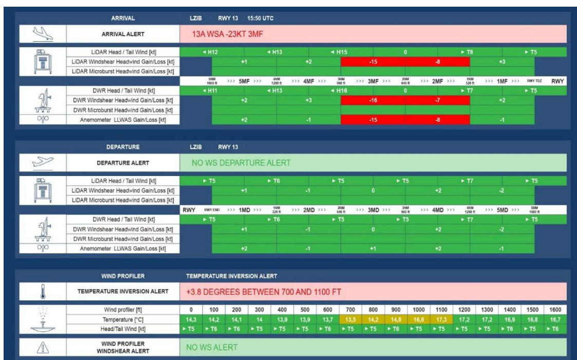
Интеграция лидара / радара / RWP / LLWAS - единая система предупреждений в результате комплексного подхода
