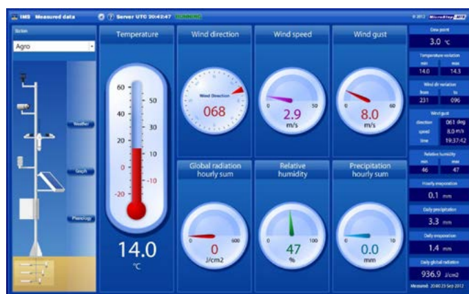
Дисплей агрометеорологической станции IMS4 с данными об окружающей среде
