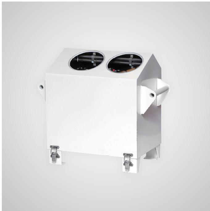
Конструкция основана на принципе LIDAR. Светоизлучающий компонент представляет собой диодный лазер малой мощности, выходная мощность которого ограничена безопасным для глаз уровнем. Он предназначен как для стационарных, так и для мобильных установок и способен одновременно обнаруживать до трех слоев облачности.
