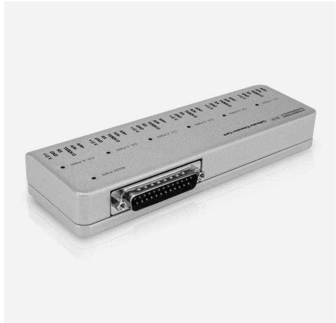
К карте расширения калибратора можно подключить 6 стандартных датчиков, обменивающихся данными через UART, SDI-12 или аналоговый выход. Используя преобразователь RS-485 или RS-232 в UART, к карте можно подключить почти почти все устройства, существующие на рынке. Карта расширения питает датчики до 12 В.
