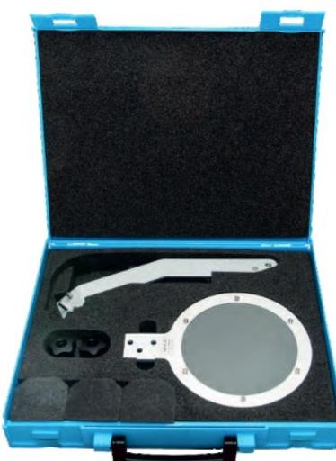
корпусе каждого датчика для их правильной установки. Каждой калибровочной табличке приписываются значения калибровки (EXCO) и эквивалентное значение видимости (MOR) на месте изготовления. Эти значения прослеживаются по эталонному трансмиссометру Королевского метеорологического института Нидерландов (KNMI - Koninklijk Nederlands Meteorologisch Instituut) в Нидерландах. После установки на датчик
