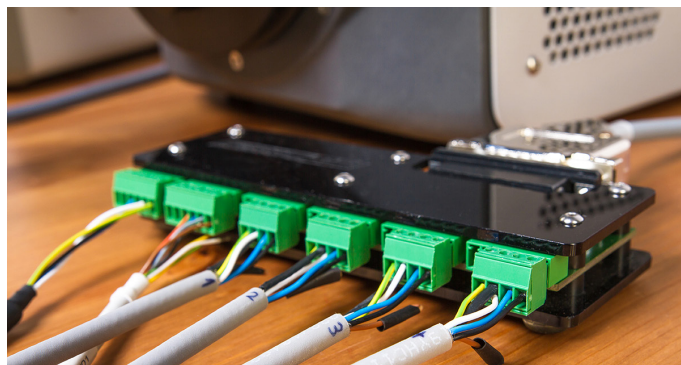
Внешняя считывающая карта для удобного подключения датчиков. Она обеспечивает подключение 6х 12 В постоянного тока, 6х 24-битный дифференциальный аналоговый вход, 6х SDI-12, 6х UART (расширяемый до RS-232, RS-485, RS-422).
