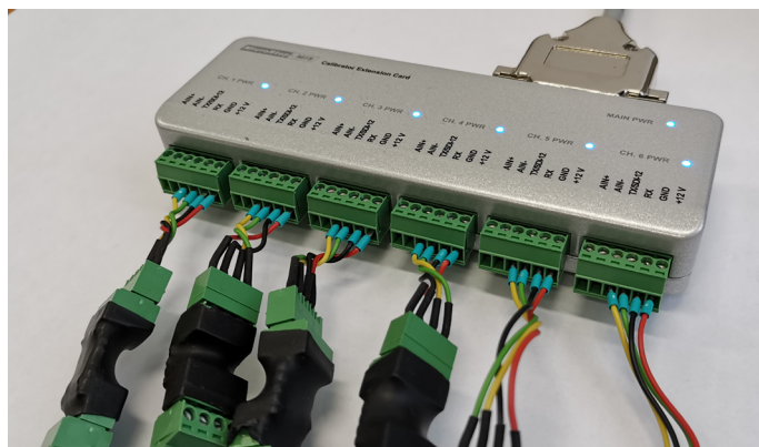
Внешняя считывающая карта для удобного подключения датчиков
