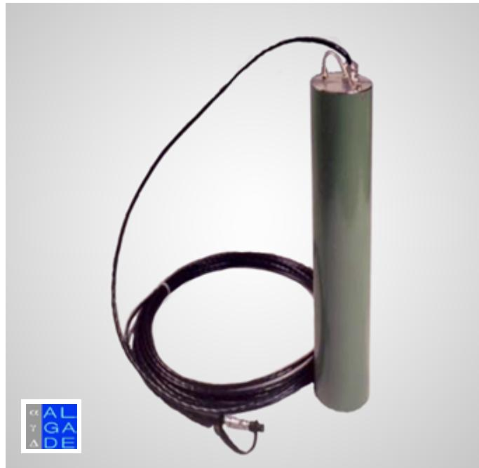
Мобильный датчик радона регистрирует альфа-частицы от радиоактивного распада  $^{222}\text{Rn}$  в измерительной камере. Радон поступает в камеру обнаружения в процессе диффузии через три фильтра из целлюлозы, которые улавливают все твердые радионуклиды. Альфа-частицы от распада радона и его вторичные частицы обнаруживаются светонепроницаемым кремниевым детектором с чувствительной поверхностью 400  $\text{mm}^2$  и глубиной истощения 100 мкм.
