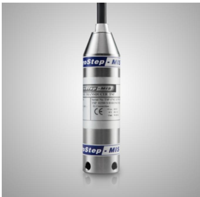
Выходной сигнал датчика давления поступает, оцифровывается и обрабатывается в ЦП с 16-разрядным аналого-цифровым преобразователем, который обеспечивает лучшую линейность датчика давления и температурную компенсацию. Выход D/A преобразовывается в 12 бит.
